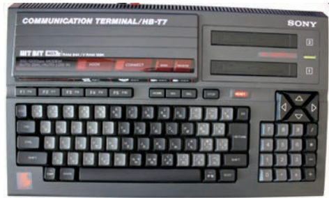
FIGURA 2.91. EL SONY HB-T7 TENÍA INCORPORADOS UN MÓDEM Y SOFTWARE DE COMUNICACIONES.
