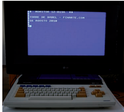
FIGURA 2.124. AL CONECTAR EL MZ-700 SE HACÍA A LA CONSOLA DEL PROGRAMA MONITOR, NO A UN INTÉRPRETE DE BASIC.
