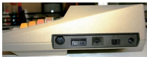
FIGURA 2.37. EN EL LATERAL DERECHO EL ATARI 800 OFRECE MÁS CONECTIVIDAD QUE EL 400.
