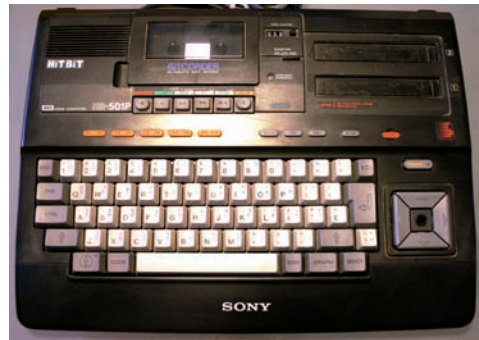
FIGURA 2.81. SONY HB-501: ESTE MODELO INCORPORABA LA UNIDAD DE CINTA.
