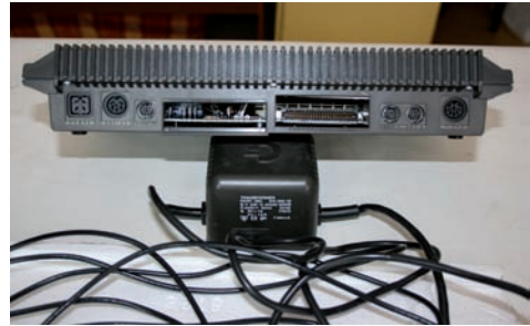
FIGURA 2.26. VISTA POSTERIOR DEL PLUS/4 CON LA MAYORÍA DE LAS CONEXIONES.
