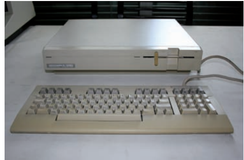
FIGURA 2.28. EL C128D INCORPORA LA UNIDAD DE DISCO Y LA FUENTE DE ALIMENTACIÓN EN UNA CAJA.
