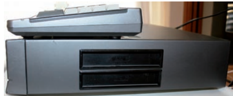
FIGURA 2.89. LOS MSX2 DE LA GAMA SUPERIOR DE PHILIPS DISPONÍAN LAS RANURAS EN EL LATERAL.
