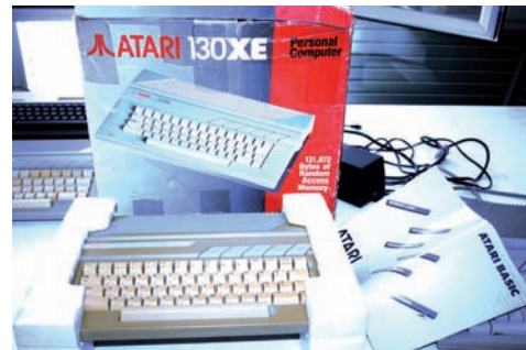
FIGURA 2.42. EL ATARI 130XE ERA BÁSICAMENTE UN 65XE CON EL DOBLE DE MEMORIA.
