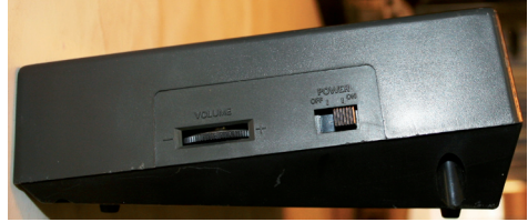
FIGURA 2.65. LATERAL DEL CPC 464 CON EL INTERRUPTOR DE ENCENDIDO Y EL CONTROL DE VOLUMEN.
