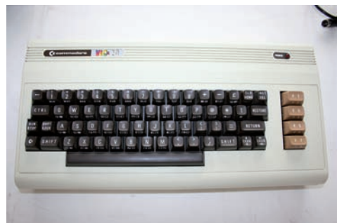
FIGURA 1.3. EL VIC-20 ERA UN MICROORDENADOR TÍPICO QUE INCORPORABA TODOS LOS ELEMENTOS DENTRO DEL PROPIO TECLADO.
