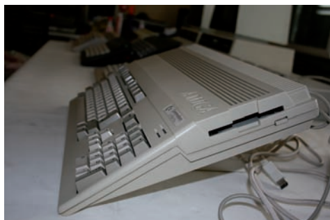
FIGURA 2.30. LA UNIDAD DE DISCO DE 3.5" SE ENCONTRABA EN EL LATERAL DEL ORDENADOR.
