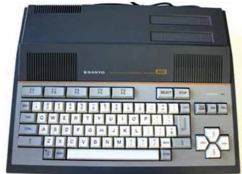
FIGURA 2.78. SANYO PHC-28S: SOBRE RANURA SUPERIOR CON TAPA INDIVIDUAL.
