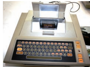
FIGURA 2.34. EL ATARI 400 TENÍA UN TECLADO PLANO Y UNA RANURA PARA INTRODUCIR UN CARTUCHO.
