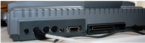
FIGURA 2.97. CONEXIONES MIDI Y DE VÍDEO EN LA PARTE TRASERA DEL FS-A1GT.
