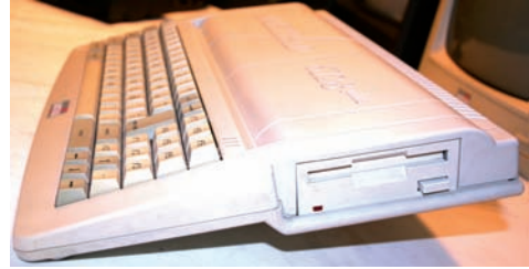
FIGURA 2.72. EL AMSTRAD 6128PLUS TENÍA LA DISQUETERA EN EL LATERA.
