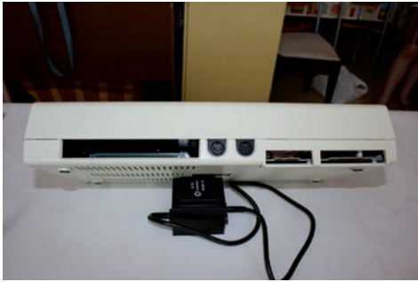
FIGURA 2.19. EN LA PARTE TRASERA DEL VIC-20 ESTÁN LAS CONEXIONES DE VÍDEO, CASSETTE Y AMPLIACIÓN.
