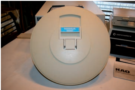
FIGURA 2.2. DISCO EXTRAÍBLE DE 14" Y 10 MB DE CAPACIDAD.
