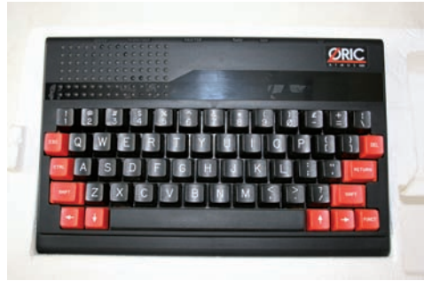
FIGURA 2.102. EL ORIC ATMOS TENÍA UN TECLADO MEJOR QUE EL DEL ORIC 1.
