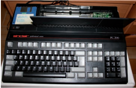
FIGURA 1.22. EL SINCLAIR PC 200 CON LA TAPA DE ACCESO A LAS RANURAS DE EXPANSIÓN ABIERTA.
