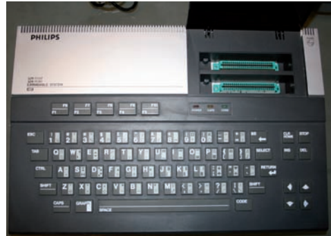
FIGURA 2.77. PHILIPS VG-8000: TECLADO PLANO Y DOBLE RANURA SUPERIOR OCULTA POR UNA TAPA.
