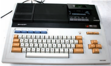
FIGURA 2.123. SHARP MZ-700 CON UNIDAD DE CASETE INTEGRADA (MODELO 721).
